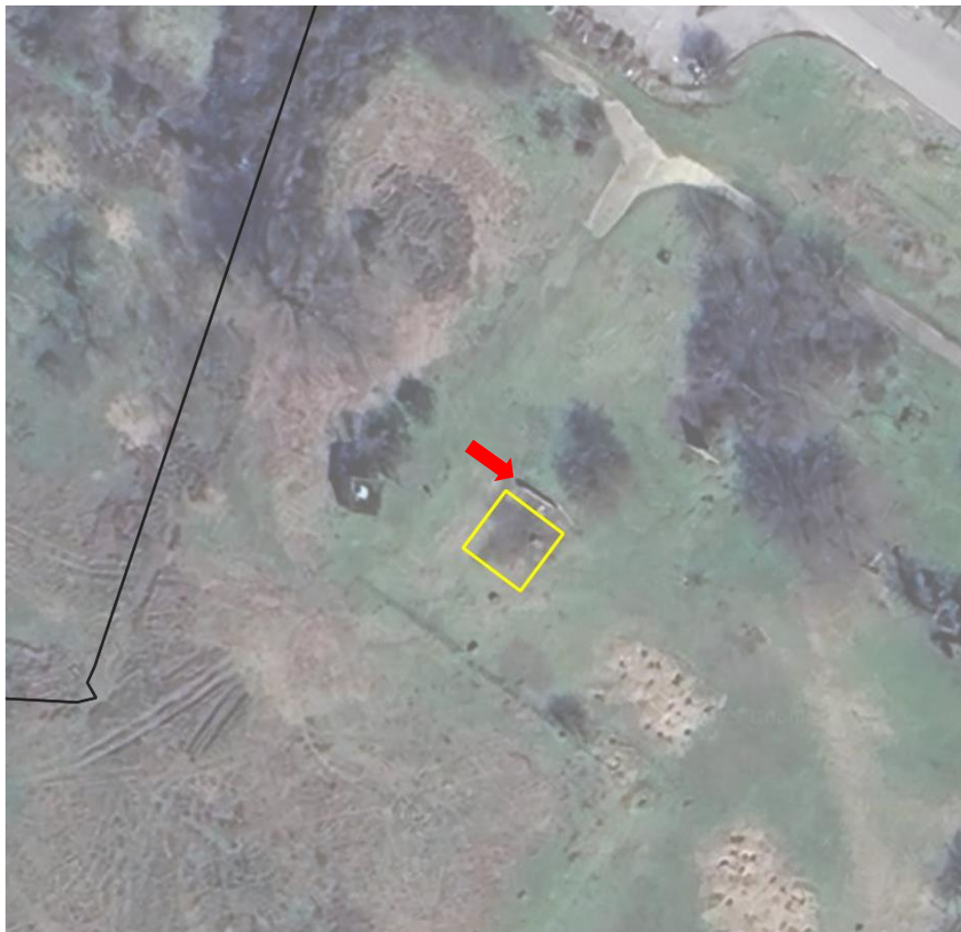
Figura 5 Geometria dell'area oggetto di bonifica (indicata in giallo) e ubicazione della tubazione di arrivo dell'oleodotto (indicata in rosso). In nero è indicato il confine tra i comuni di Bertonico e Turano Lodigiano
